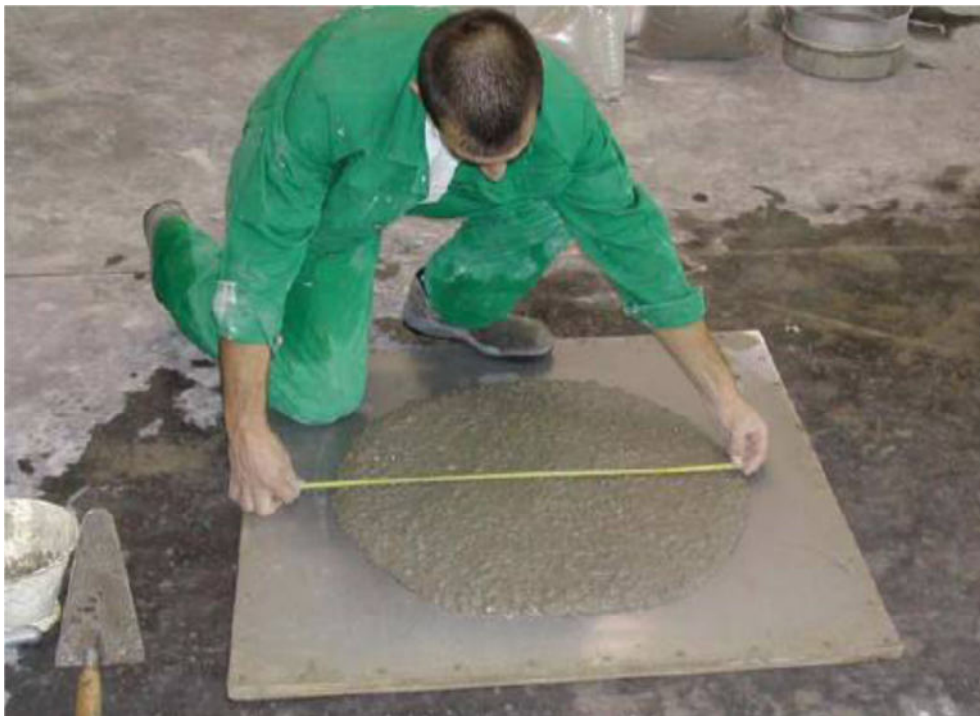
(3) Obr. 3 – Zkouška rozlití SCC - správně navržená směs
